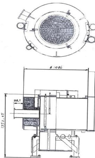
Gambar 1. Reflektor tampak dari atas dan samping [5]
