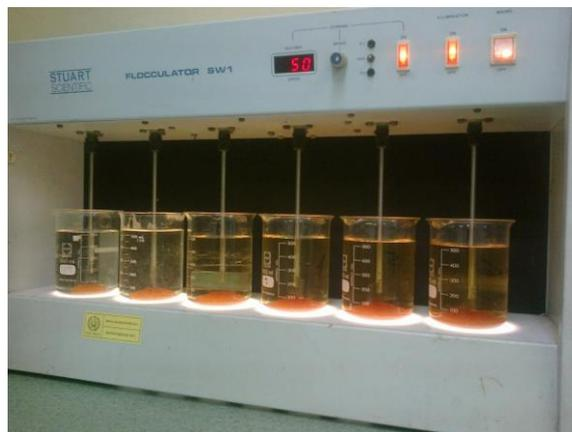
**Gambar 1.** Pengolahan penukar ion menggunakan metode *jar test*
