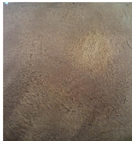
Gambar 4. Pulp terbaik pada kondisi operasi 90°C dan waktu 80 menit
