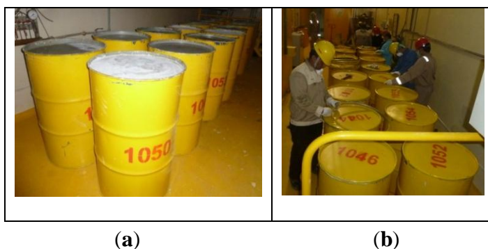
Gambar 7. Proses Pengeringan Semen (a) dan Penguncian Drum (b)
