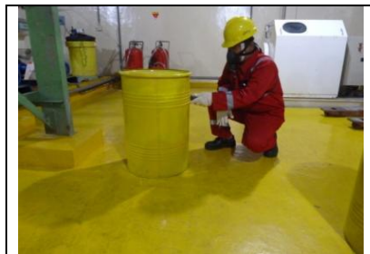
Gambar 3. Pengukuran Paparan Radiasi Limbah Pascapreparasi
