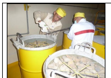
Gambar 5. Pemasangan Palang Antidispersal dan Penguncinya
