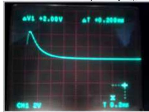
Gambar 8. Pulsa tegangan lucut pada sistem ADPS
