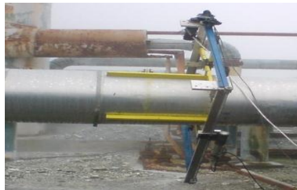
Gambar 5. Investigasi kerak pada pipa aliran steam secara online di lapangan pasa bumi PT. Geo Dipa Energi, Wonosobo, Jawa Tengah
