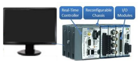
Gambar 3. Perangkat Keras Konfigurasi Simulasi Sistem Instrumentasi dan Kendali Reaktor berbasis NI-PXI [2]
