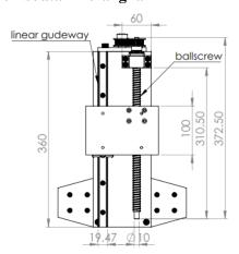
**Gambar 6**. Kerangka sumbu-y dan pemasangan *sparepart* pada kerangka
