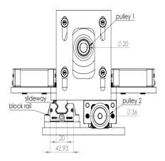
**Gambar 7**. Dudukan Motor penggerak sumbu-y
