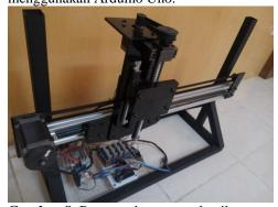
**Gambar 8**. Rancang bangun mekanik *ballscrew* dua derajat kebebasan
