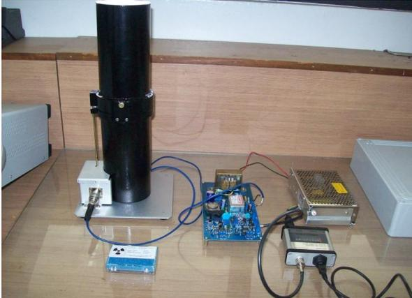
Gambar 9. Perangkat pemantau radon dengan *radon flash detector*
