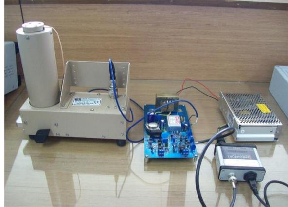
Gambar 10. Perangkat pemantau radon dengan *alpha beta sample counter*
