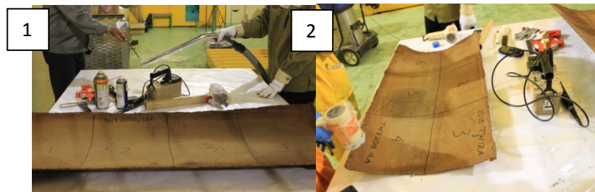
Gambar 4. Proses pembersihan kotoran dan mapping grid lembaran pelat 1) , dan pengukuran tingkat kontaminasi permukaan dan paparan radiasi 2)
