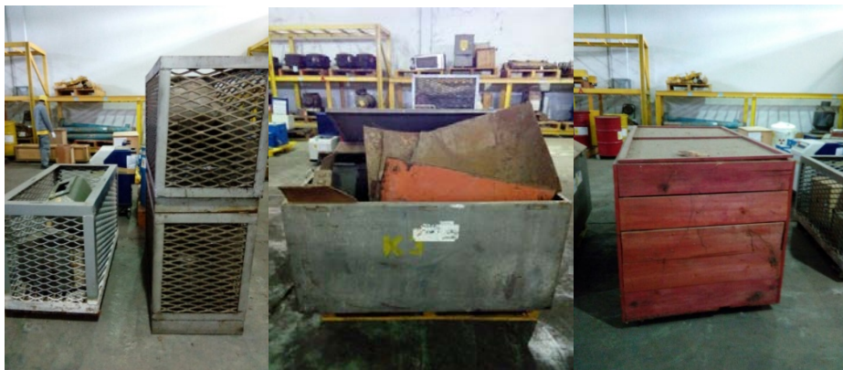
Gambar 2. Kondisi Penyimpanan Limbah Pelat Hasil Dekomisioning Fasilitas Pemurnian Fosfat
