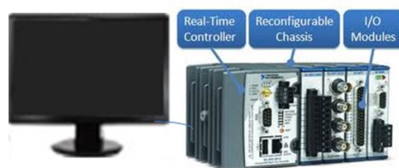
Gambar 4. Perangkat Keras Konfigurasi Simulasi Sistem Instrumentasi dan Kendali Reaktor [2]
