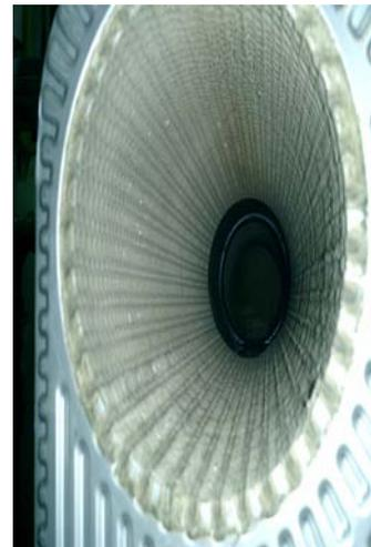
**Gambar 3. Pengamatan visual endapan yang terbentuk pada permukaan pelat penukar panas**
