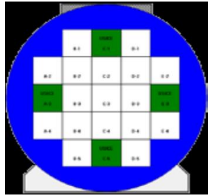
Gambar 2. Konfigurasi 1 elemen kendali pada posisi A3, C1,C5, E3.
