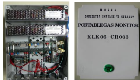
Gambar 3. Hasil pembuatan interface sistem monitor radiasi PGM-102
