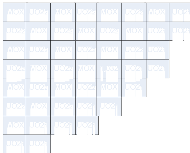
Gambar 4. Desain teras MOX PWR AP1000[5].
