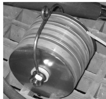
Gambar 2. Pengukuran pH celah pasangan kupon dalam rangkaian rak setelah pencelupan 1 tahun di kolam penyimpanan reaktor RSG-GAS.
