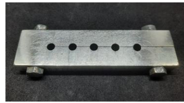
Gambar 4. Foto Mould Uji Kuat Tekan.
