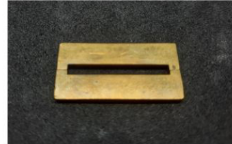
Gambar 5. Foto Mould Uji Kuat Lentur.
