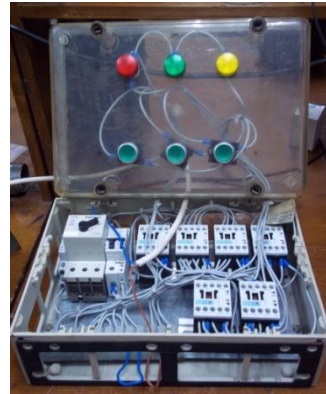
Gambar 4. Hasil perakitan simulator panel kontrol aktuatur katup sistem purifikasi primer KBE01
