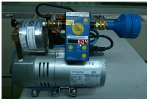
Gambar 1. Alat pencuplik udara
