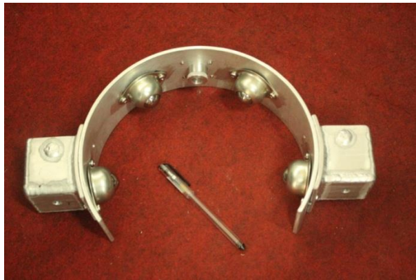
Gambar hasil fabrikasi alat bantu pemegang probe UT
