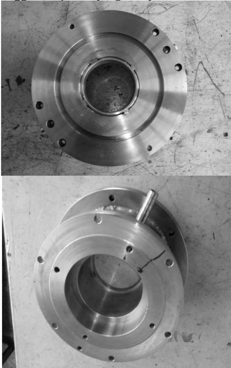
Gambar.5. Foto tabung pendingin reaktor sinter
