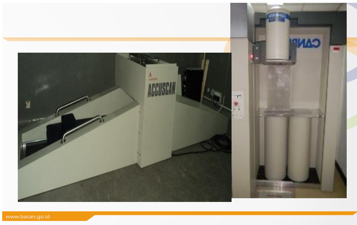
Gambar 1. Peralatan whole body counting (WBC) untuk analisis dosis internal secara langsung
