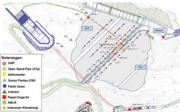
Gbr. 3. Denah Instrumen Bendungan Tapin.
