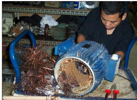
Gambar 4. Pembongkaran gulungan motor [2]
