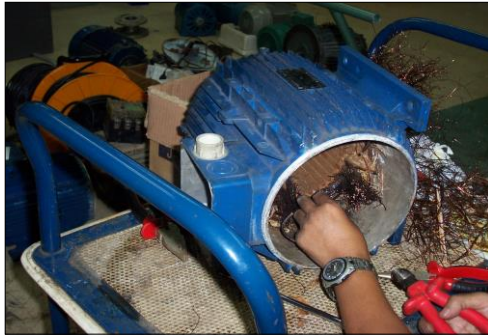
Gambar 5. Menyusun gulungan pada alur motor [2]
