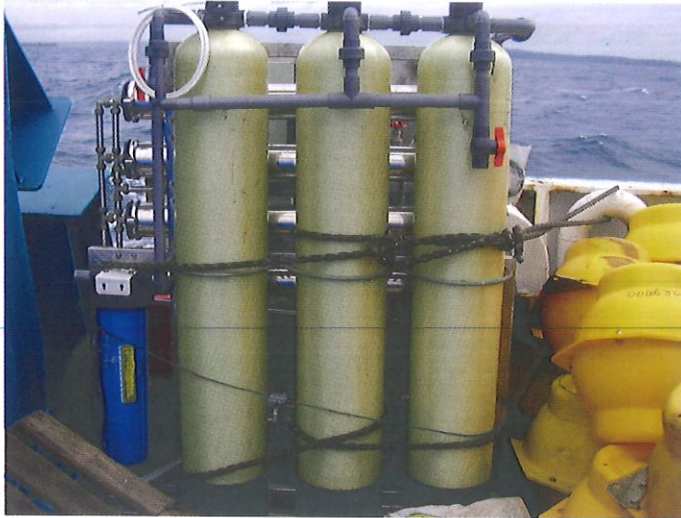
Gambar 3.1. Peralatan penjernih air dengan filter bertingkat dan sterilisator.
