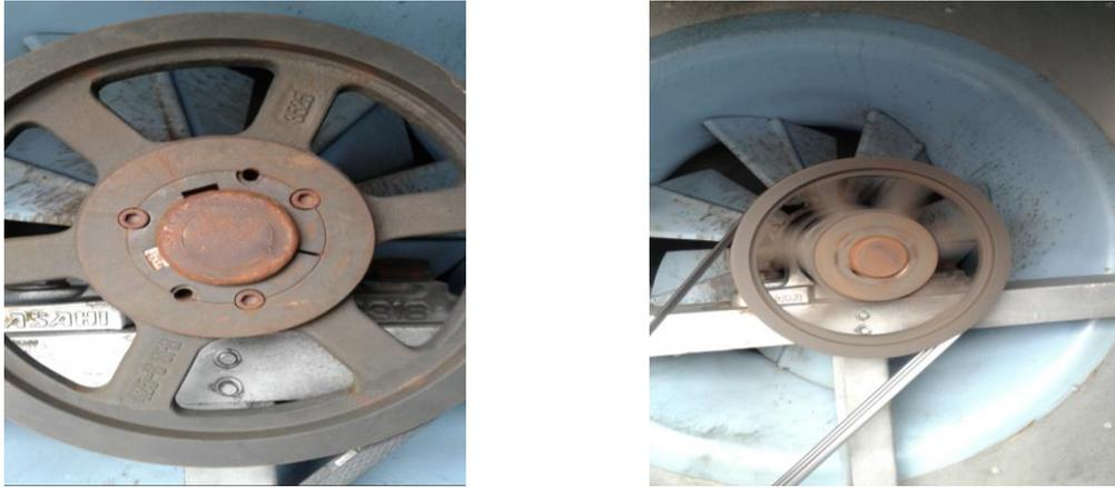
Gambar 5. Hasil perbaikan pully blower CDT-2.1
