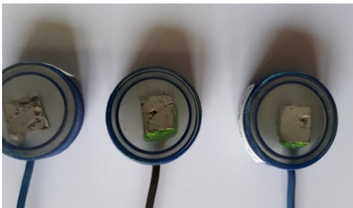
Gambar 1 Hasil pembingkai sampel uji korosi komposit keramik \text{SiC/SiC}_f
