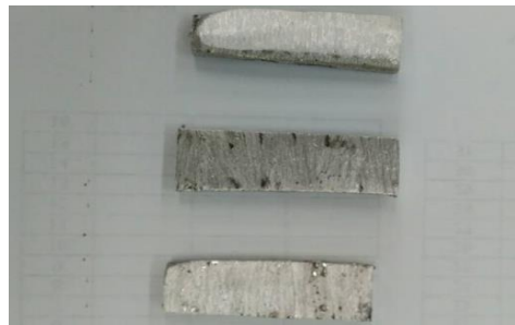
Gambar 2 Sampel uji korosi komposit \text{Zr/SiC}_f
