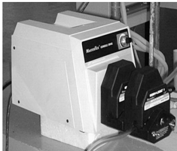
Gambar 1. Pompa peristaltik dengan roller 7 buah hasil modifikasi
