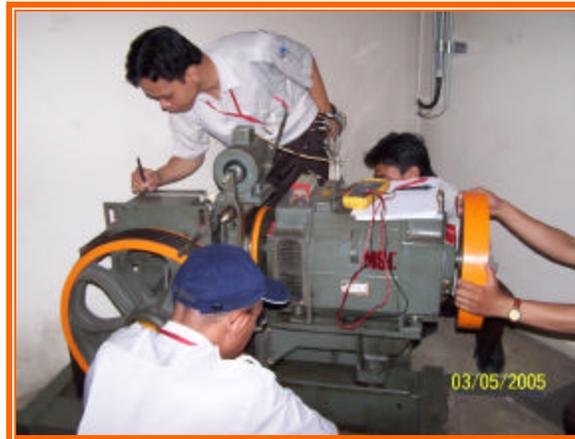
Gambar 2 Pengukuran sebelum motor dibongkar
