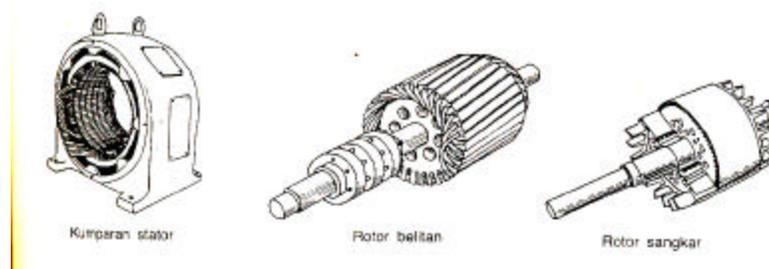
Gambar 1 Konstruksi dari motor listrik
