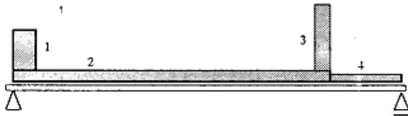
Gambar 3. Diagram kerapatan beban untuk perhitungan momen perangkat di luar teras.
