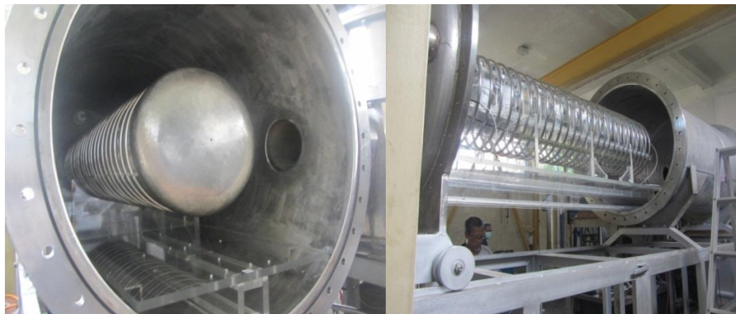
Gambar 6. Hasil Instalasi Sistem Tegangan Tinggi Cockcroft Walton pada Bejana Horizontal
