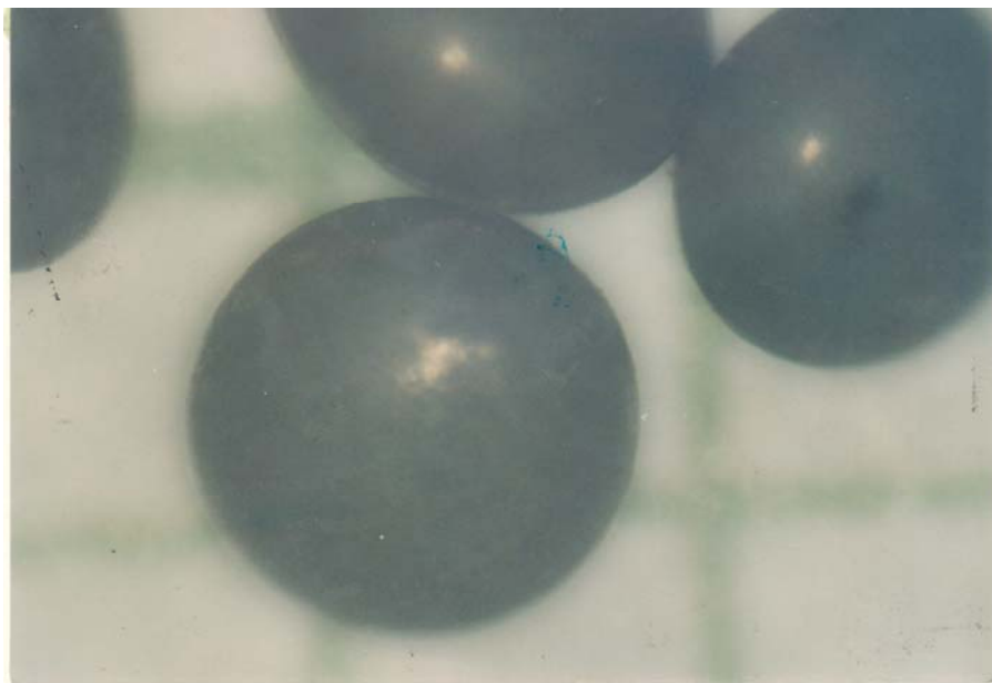
Gambar 5 b. Bentuk mikroskopis morfologi kernel oksida U_3O_8 yang diamati dengan menggunakan Mikroskop optis Tipe 150 Year pada pembesaran 12,5 X
