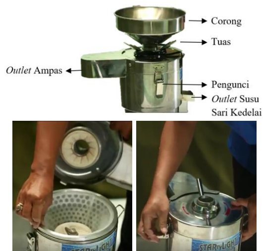
Gambar 3 Bagian Mesin Penggiling Kedelai
