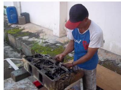
b). Pembersihan block mesin genset
