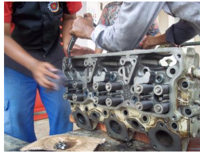
a). Pembongkaran mesin genset
