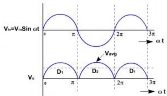
Gambar 7. Sinyal keluaran penyearah gelombang penuh 2 dioda
