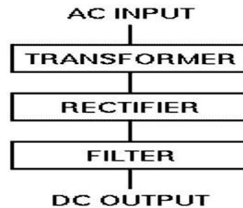
Gambar 1. Bagian Utama Penyearah Gelombang
