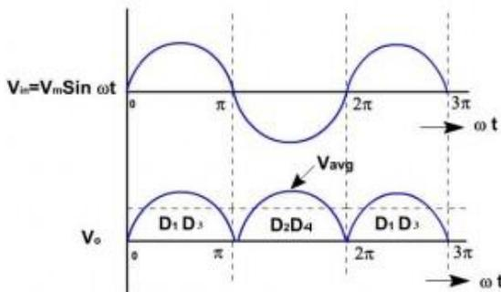
Gambar 5. Sinyal keluaran penyearah gelombang penuh 4 dioda
