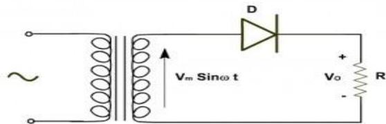
Gambar 2. Penyearah setengah gelombang
