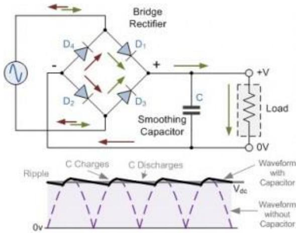
Gambar 8. Penyearah gelombang penuh 4 diode dengan kapasitor
