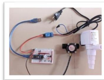
Gambar 7. Pengujian Sensor Flow
