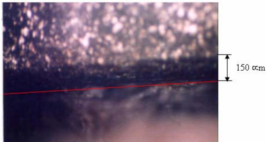
Gambar 7. Struktur mikro pada penampang melintang dari material baja ST 42 sesudah proses nitridasi dengan suhu mencapai 370 °C dan waktu deposisi 3 jam (Nital 3% , perbesaran 100 X).
