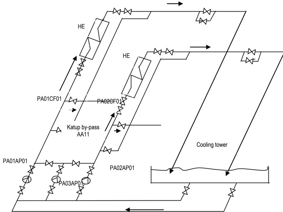
**Gambar 4.** Arah aliran air ketika katup *by-pass* AA11 dibuka.
