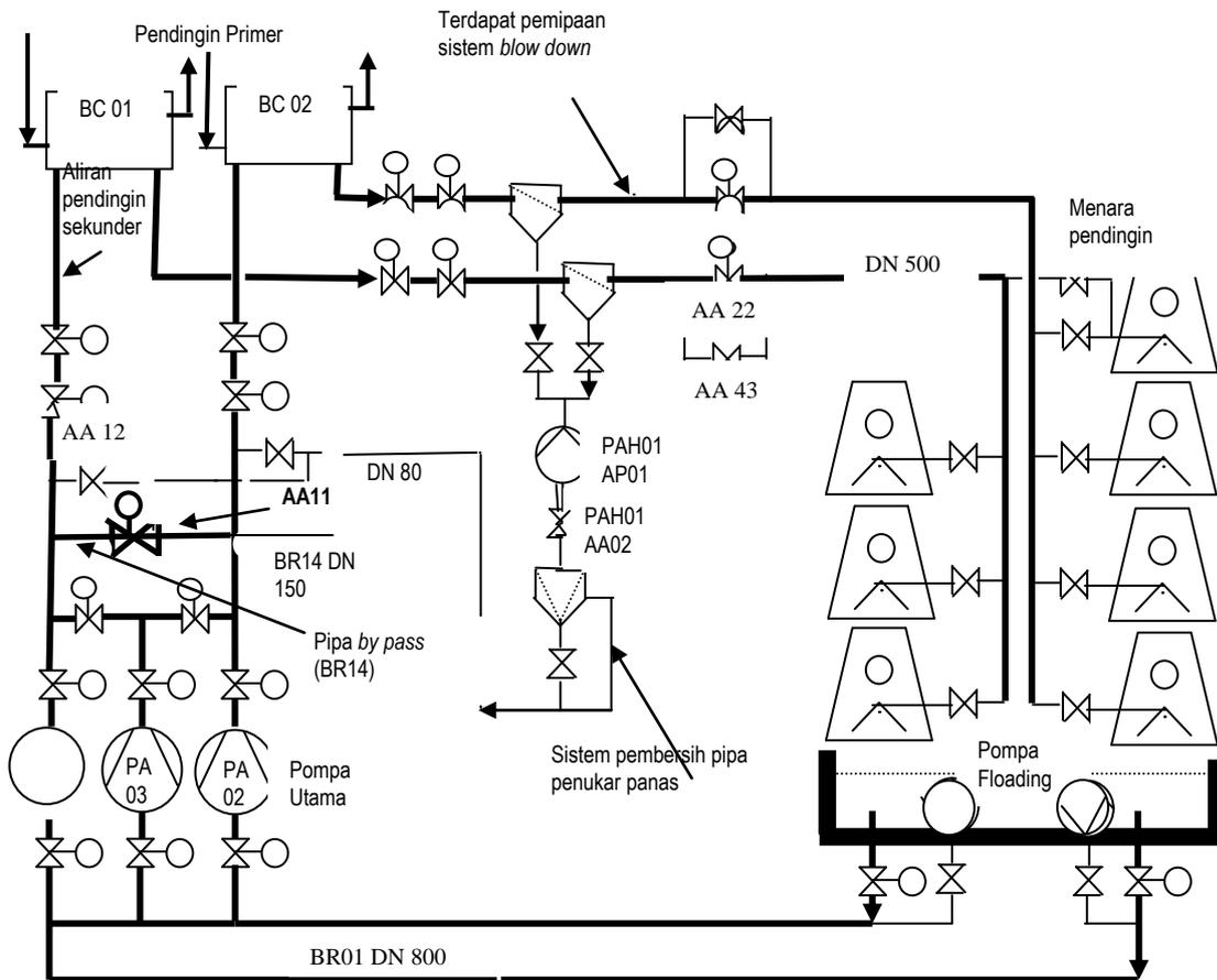
**Gambar 3.** Blok Diagram Sistem Pendingin Sekunder RSG-GAS yang direncanakan.
