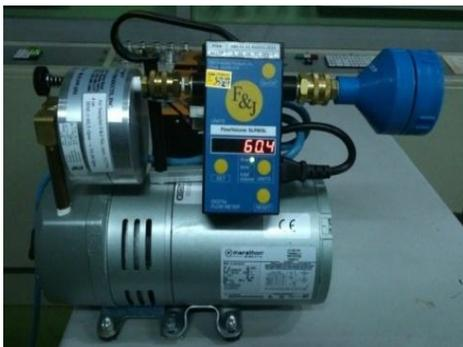
Gambar 1. Alat pencuplik udara (*air sampler*)
