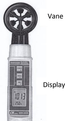
Gambar 3. Alat ukur tekanan udara Lutron model ABH-4225
