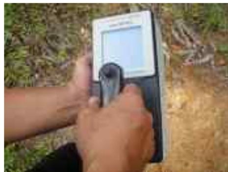
Gambar 2. Pengukuran laju dosis menggunakan Exploranium GR-130.
