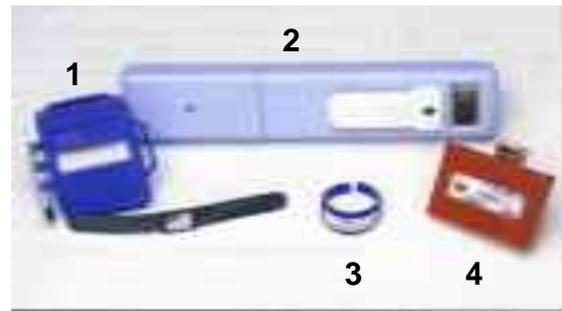
Gambar 1. Jenis dosimeter Fisik yaitu Film Badge (1) Dosimeter Poket (2), Dosimeter cincin (3), dan TLD (4)
