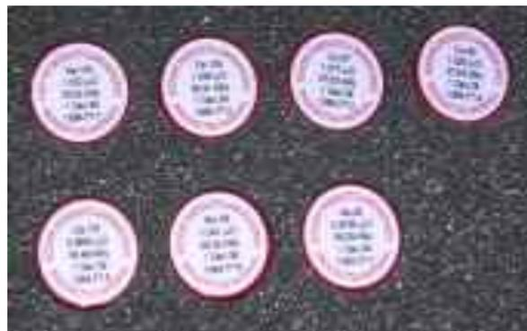
Gambar 3. Sumber standar yang digunakan untuk kalibrasi spektrometer gamma *in situ*.
