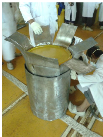
Gambar 2. Pelapisan drum dengan lembaran Pb
