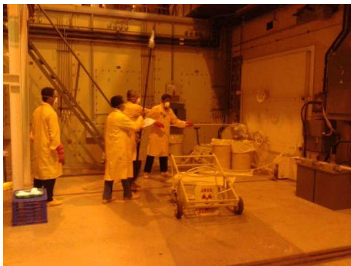
Gambar 1. Pengukuran paparan radiasi limbah radioaktif dari ZG 103.
