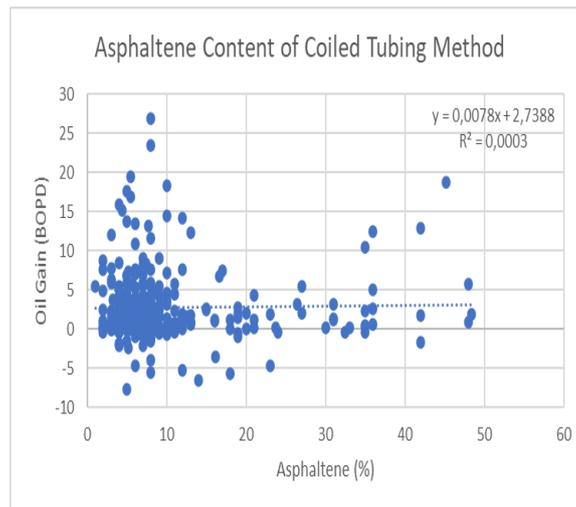
**Gambar 7.** Grafik Linier Kadar Asphaltene Metode Coiled Tubing
