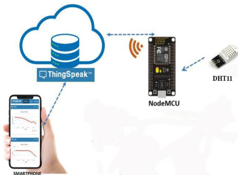
Gambar 3. Integrasi sistem dengan platform IOT Thingspeak
