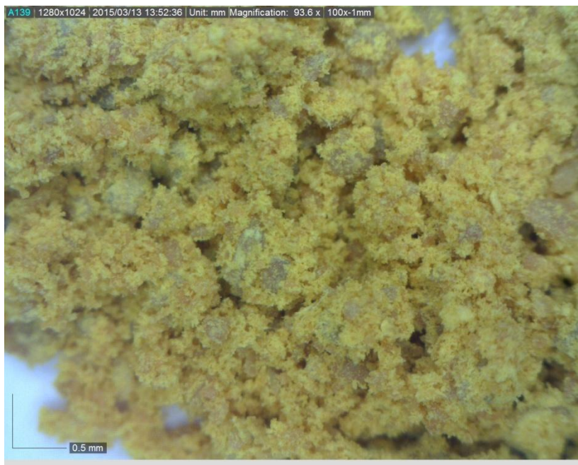
Gambar y : Yellow cake dari Kalimantan berwarna kuning dan di permukaan butirannya nampak ada seperti serbuk.
