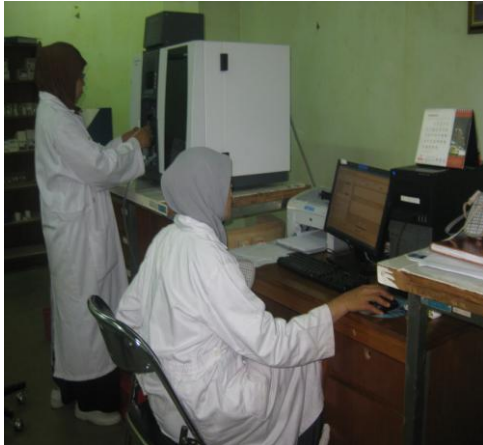
Gambar 1. Kegiatan analisis unsur-unsur pengotor menggunakan AAS
