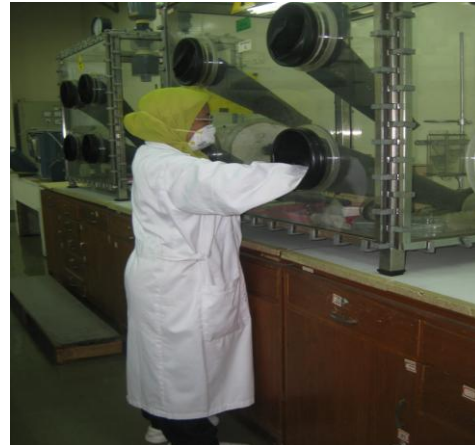
Gambar 2. Kegiatan pengujian tap density Serbuk UO_2
