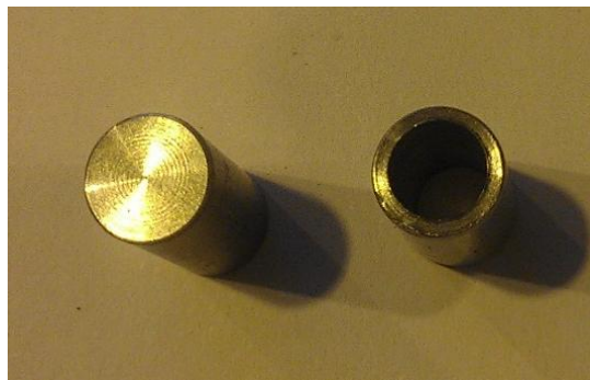
Gambar 1. Paduan Zr(NbSnFeMo) bentuk rod dan tube [8] .
