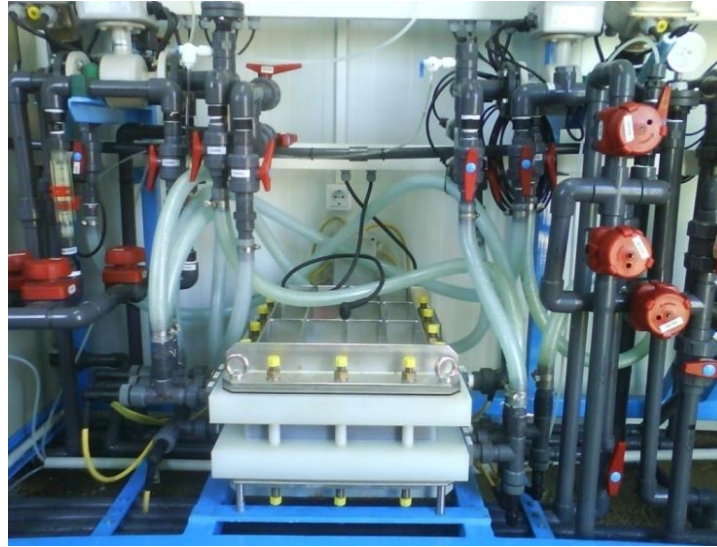
Gambar 2. Proses pemurnian uranium dari air laut menggunakan metoda elektrodialisis sistem barrier [14-15]
