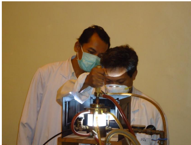
Gambar 2. Pembuatan paduan U-7Mo.xZr, U-7Mo.xSi, U-7Mo.xTi menggunakan tungku busur listrik.
